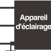
7. Placez l'étiquette fournie dans l'espace extérieur du luminaire une fois l'installation du moteur à LED terminée. L'étiquette doit être visible.
